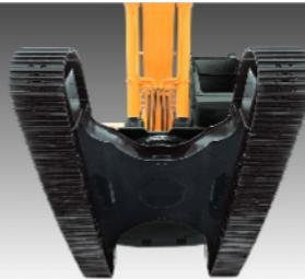
Marco de sección en caja reforzado, soldado de acero de baja tensión y alta resistencia. Garantiza seguridad y resistencia contra impactos externos al circular por terrenos accidentados y trabajar en sitios húmedos mediante paneles de acero de alta resistencia a la tracción, con rodillos superiores e inferiores y protectores de orugas de gran durabilidad.
