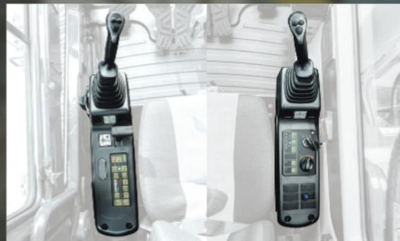
Los interruptores y otros controles esenciales se encuentran cerca del operador. Esto ayuda a mantener el movimiento del operador al mínimo, mejorando el control con menos fatiga del operador.
