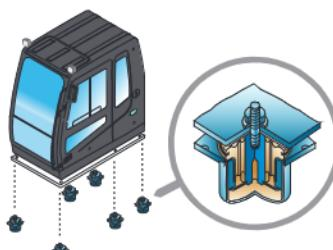
La aplicación de Viscous Mounting al soporte de la cabina proporciona al operador una conducción mucho mejor. La eficiencia del trabajo del operador aumentará a medida que disminuyan los impactos y el nivel de ruido en la cabina.
