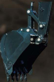
El varillaje de la cuchara sellado y ajustable proporciona menos desgaste de los pasadores y casquillos, así como un funcionamiento silencioso. El diseño incluye la durabilidad del eslabón de la cuchara y funciones anti desgaste. Placas de refuerzo adicionales en la sección del filo. La cuchara reforzada está fabricada con acero más grueso y placa lateral adicional.
