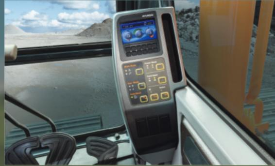
El panel de instrumentos está instalado frente a la caja de la consola derecha. Verificación sencilla de todos los sistemas críticos con indicadores fáciles de leer.
