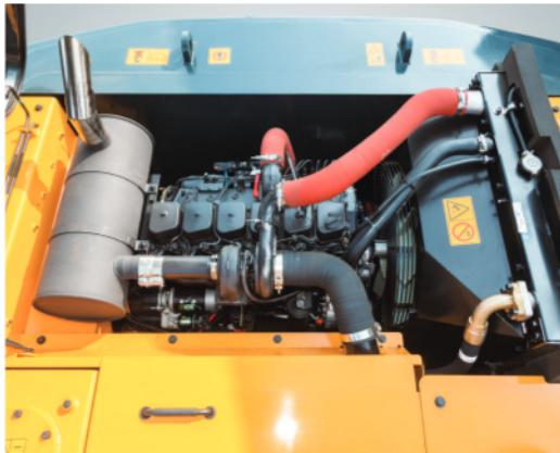
El sistema de refrigeración se proporciona para un funcionamiento óptimo, lo que garantiza una mayor vida útil del motor y los componentes hidráulicos. El servicio del motor y el sistema hidráulico se simplifica considerablemente debido a la accesibilidad total
