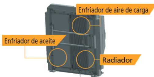
1. Enfriamiento mejorado al cambiar a una estructura de tipo de 3 columnas seguidas
